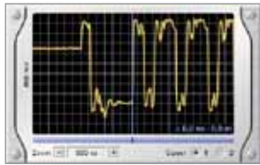
Una forma d'onda anomala dovuta a problemi sulla rete (Figura 4) e una forma d'onda corretta, che indica il buon funzionamento della rete (Figura 5)
